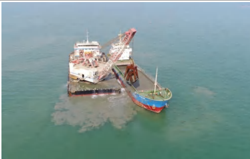
图 3.4-3 抓斗式挖泥船施工
