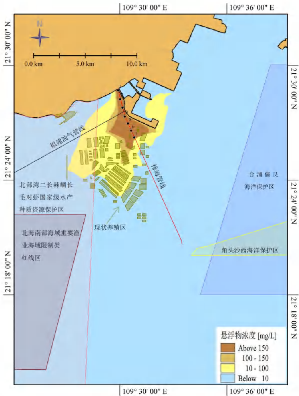
图 7.2-3 临时水上作业区回填施工悬浮物代表点影响范围包络图
